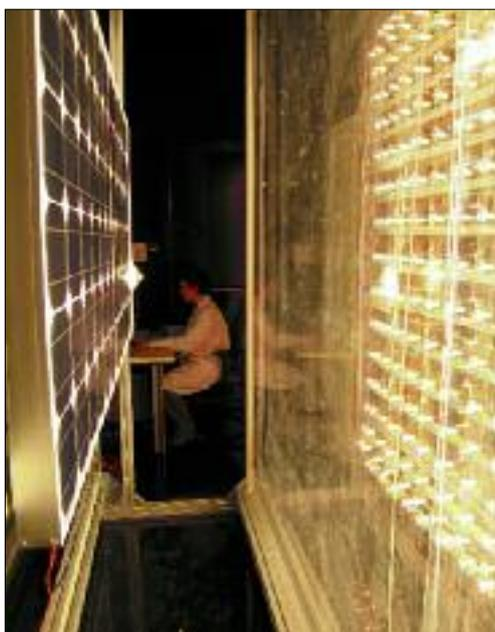
Simulador solar en funcionamiento.
